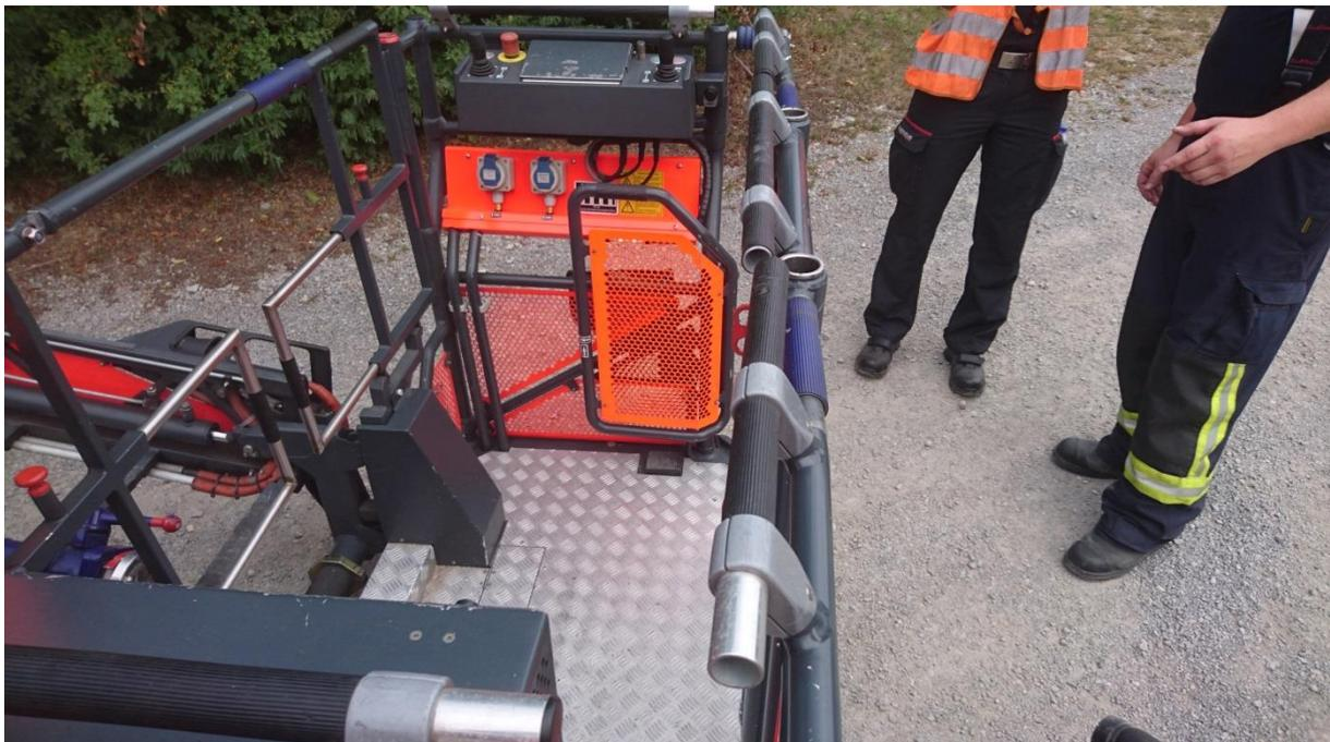
*Bild 3 Die Reling hat sich durch die Zugkraft nach außen verbogen.
