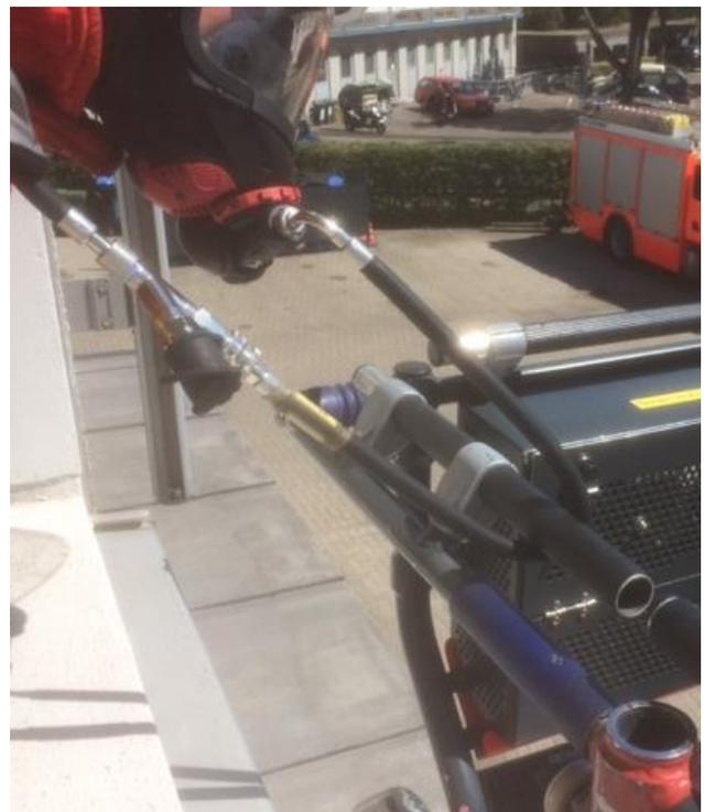
*Bild 2 Der Lungenautomatenschlauch hakt sich an der Reling des Korbes ein (Bild nachgestellt)*
