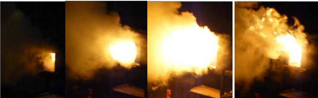
**Nach Öffnen der Tür und der folgenden Vermischung von Luft und Brandgasen kommt es zum Backdraft**
