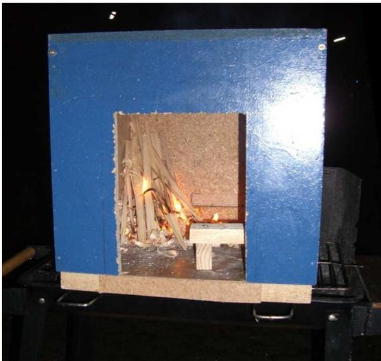
Das Doll’s House besteht aus Spanplatten ist im Endeffekt ein Würfel, in den eine Öffnung geschnitten wurde, welche die Tür zum Raum darstellt. Durch ein Stützfeuer in einer Ecke der Box wird der Würfel aufgeheizt, die Spanplatten thermisch aufbereitet und somit Pyrolysegase freigesetzt. Diese bilden zusammen mit den Verbrennungsprodukten des Stützfeuers eine Rauchsicht, die sich langsam in der Box ansammelt, genau wie bei einem Zimmerbrand.
