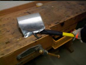
Der Schnitt wird durch Hebelbewegungen mit der Stoßklinge (Bewegungsrichtung auf-ab) weiter fortgeführt.
