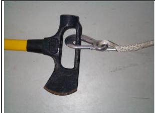
In der einfachsten Variante wird der genormte Karabinerhaken der Feuerwehrleine im Grifffenster der Axt eingeklinkt.
