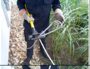
Wenn bereits beide Enden des Seiles festgebunden worden sind, wird nur eine Schlaufe durch das Grifffenster gestochen und ähnlich wie beim Ankerstich über die Axtklinge geklappt.
