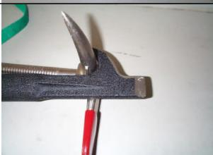
Zuerst wird der Dorn des Haligan- Tool unter den Haken des TNT- Tool gesteckt.
