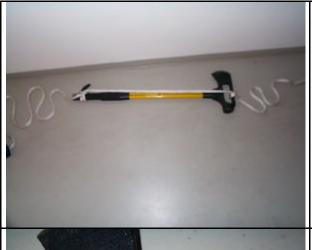
Seilgeführter Werkzeugtransport: Soll das Werkzeug beispielsweise diagonal hochgezogen werden, um sich nicht an einer Häuserfassade zu verhaken bietet sich das hier gezeigte Einbinden oben und unten an.
