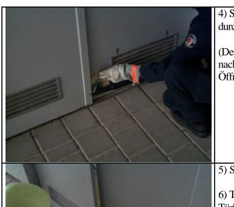
4) Spreizung weiterführen, bis ein durchgängiger Spalt entstanden ist.
