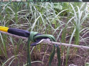
Eine etwas aufwendigere, dafür bessere Sicherung kann mit einem Mastwurf um Zugseil und Axtfuß durchgeführt werden.
