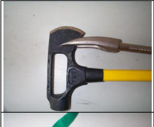
Dann wird die Klaue des Haligan- Tool mit dem Schlitz über die Axtklinge geschoben, bis sie dort festklemmt.
