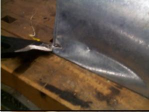
Eine Erstöffnung, hergestellt mit einem Rammstoß mit der Spitze der Stoßklinge.
