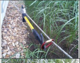
Ein schnelle Sicherung der aufgebrachten Seilspannung kann wie hier mit einem vorher in das Zugseil eingeklinkten Karabinerhaken bewerkstelligt werden.
